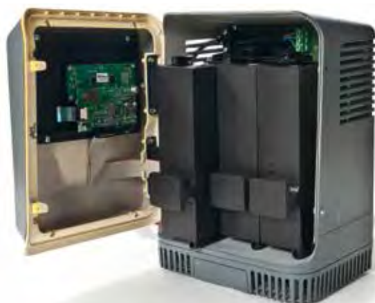
interno del cabinet a 3 slot
